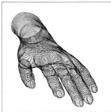
(b) 測定したデータをB-スプライン変換によって形状を自由曲面として生成
